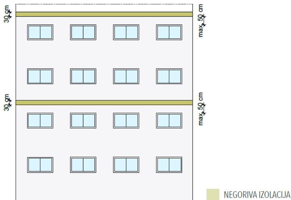
Слика. Протупожрни хоризонтални континуирани појас најмање 30 см око цијеле зграде на свакој другој етажи, највише 50 см изнад горњег руба отвора
